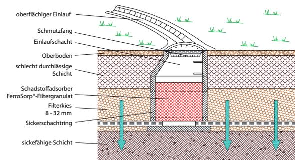
Einsatz von FerroSorp® RW bei der Schachtversickerung
